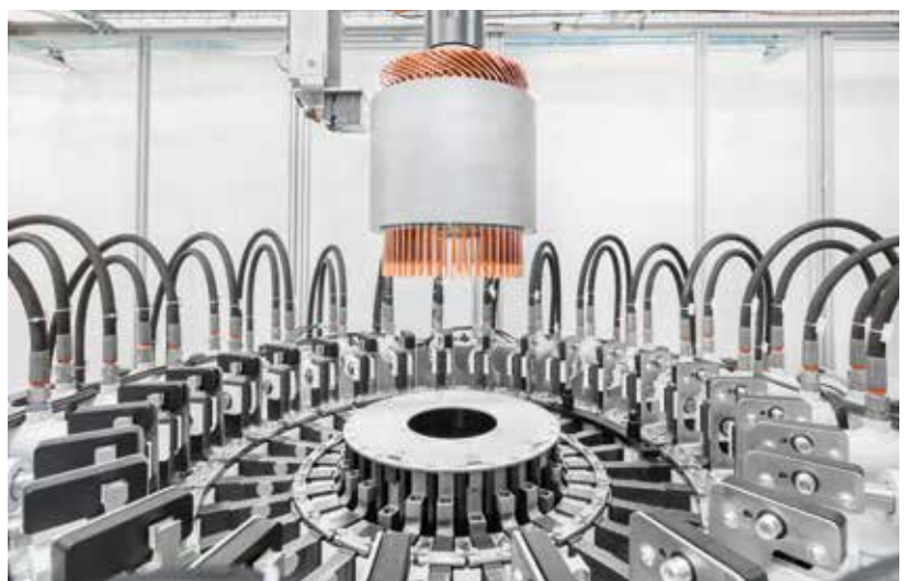
Zur Herstellung von Statorsegmenten für Elektromotoren werden die einzelnen Segmente wie Haarnadeln geformt. Die manuellen Prozessschritte entfallen. Deshalb wird diese Technologie den Anforderungen einer Großserienproduktion besonders gerecht.
