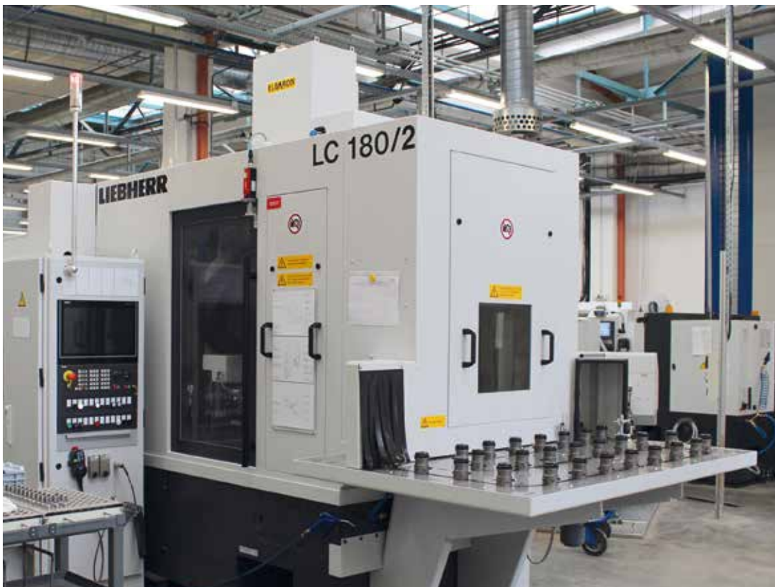
Wälzfräsmaschinen produzieren Schneckenräder, Räder und Wellen.
