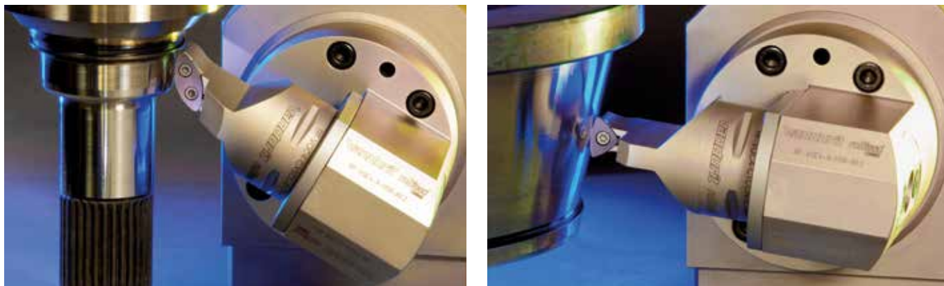
Das Verfahren ist frei programmierbar. Es entstehen komplexe Konturen wie Planflächen, Schrägen sowie konvexe und konkave Flächen.
