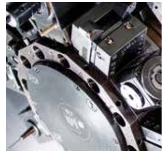
In elektromechanischen Systemen sorgt ein Schleifring für die ungehinderte Rotation von Leistungsringen.
