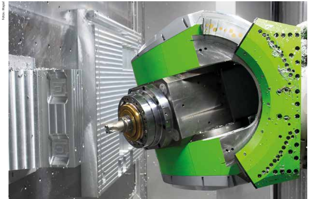
Wie füreinander geschaffen: Das Horizontalbearbeitungszentrum, der 3-Achs-Fräskopf und der ISO-Eckfräser erreichen im Zusammenspiel beste Ergebnisse.
