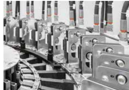
Zur Herstellung von Statoren für Elektromotoren werden die einzelnen Segmente wie Haarnadeln geformt.
