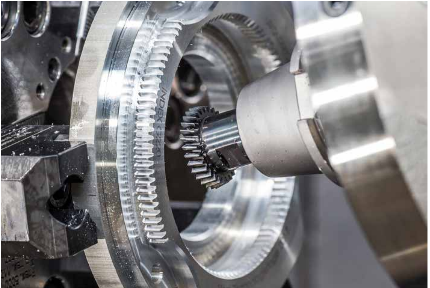
Späne sind beim Wälzschälen der kritische Punkt.
