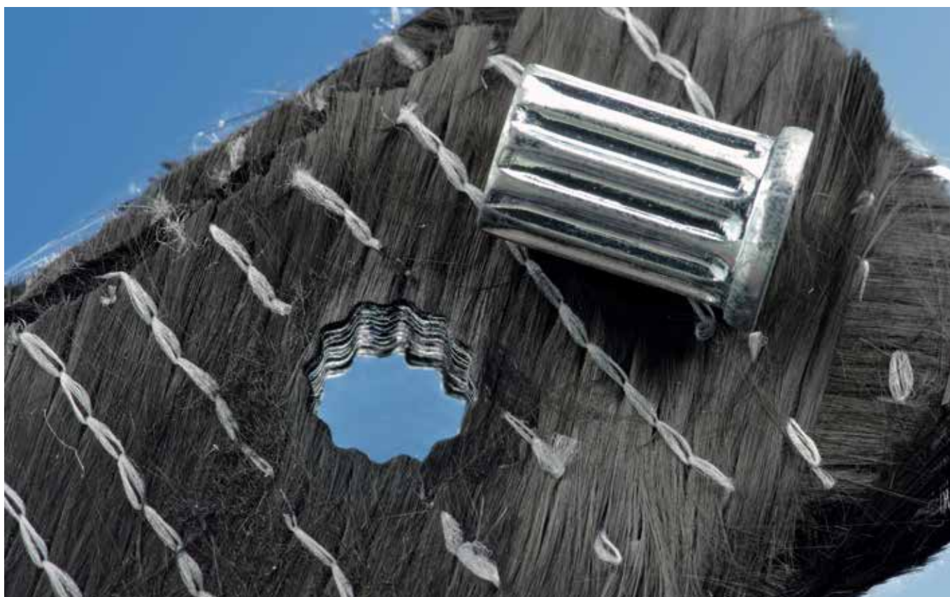
Laserstrahlgebohrter CFK-Preform mit einer Innengewindehülse.
