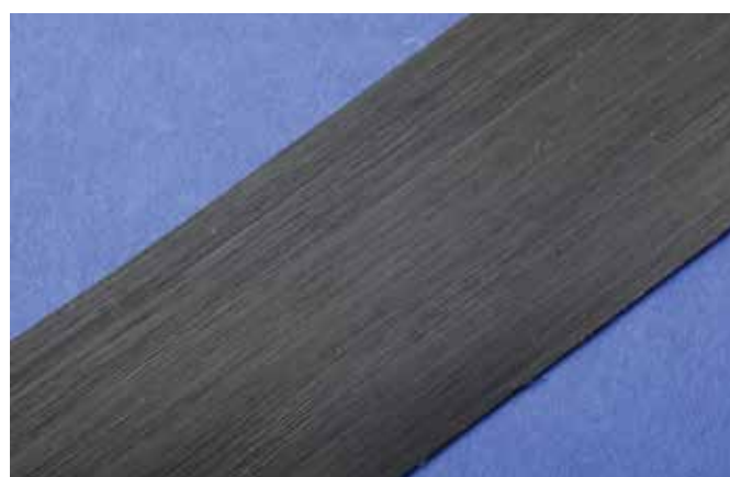
Tapes mit Endlosfasern: Die lastenoptimierte Auslegung der Bauteile hilft bei der Reduzierung des Gewichts.
