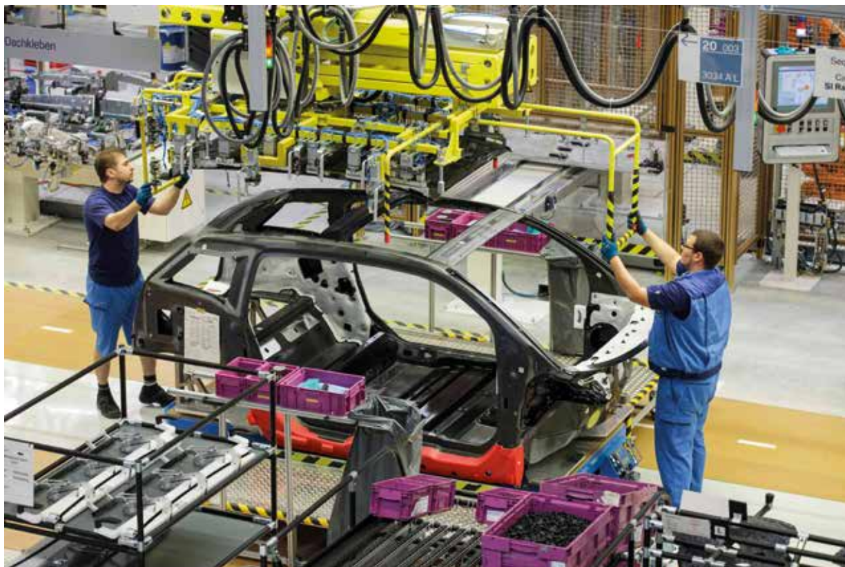
Hybride Bauweise wird für Fahrzeugkarosserien genutzt. Die Elektromobilität ist ein Treiber für den Leichtbau. Stahl wird zunehmend mit anderen Materialien wie faserverstärkten Kunststoffen verbunden.
