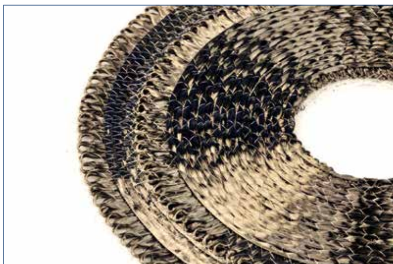
Technische Stickmaschinen erlauben die radiale und axiale Ablage der Fasern gemäß der im Bauteil ermittelten Krafftflussverläufe.
