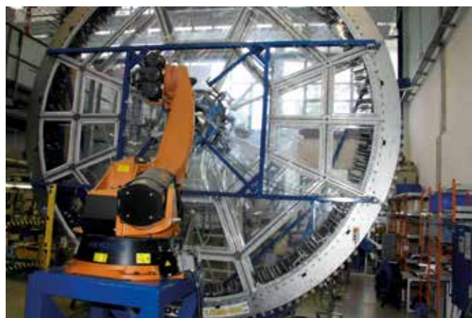
Automatisiertes Flechten von Carbonfasern ermöglicht leichte Strukturen bei den Bauteilen.
