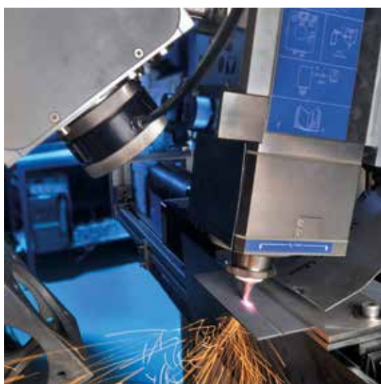
Laserschneiden mit nachgeführtem Wärmebehandlungslaser. Eine lokale Wärmebehandlung kann durch Einprägen weicher Zonen die Crasheigenschaften der Bauteile verbessern.
