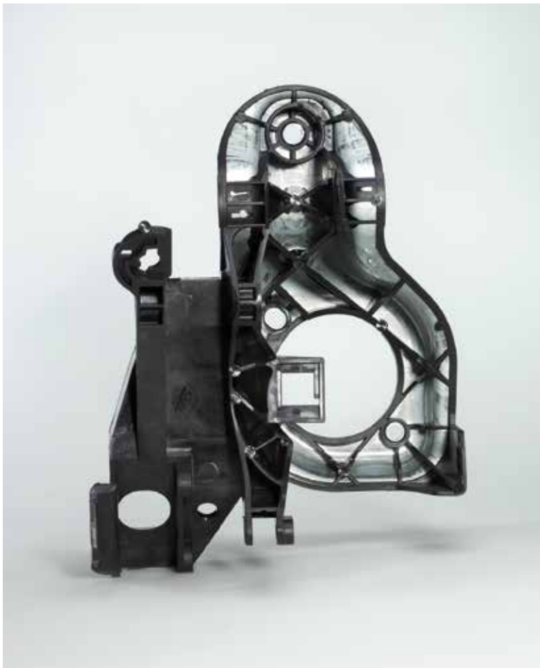
In Hybridtechnik ausgeführter Pedallagerbock: Dünnwandige Blechprofile werden im Spritzgießwerkzeug gezielt mit Polyamid-Verstärkungen versehen.
