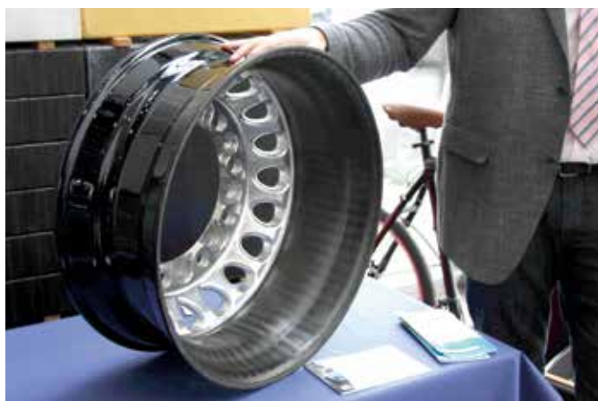
Mobilität gewinnt an Bedeutung und muss deshalb ressourcenschonend erfolgen. Durch Materialmix entstehen Felgen für Autos in Leichtbauweise.
