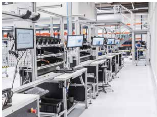
Ein digitales Assistenzsystem unterstützt bei der Montage und vereinfacht dadurch komplexe Arbeitsprozesse.
