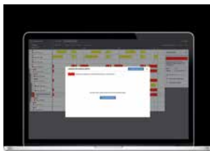
Visualisierung: Bei einer Störung der Anlage wird die Ursache des Alarms angezeigt. Nicht hinterlegte Fehler können schnell ergänzt werden.
