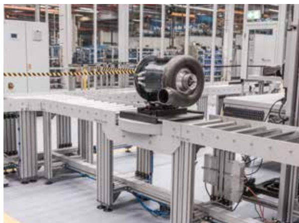
Montagelinie für High Speed Turbo-Kompressoren.
