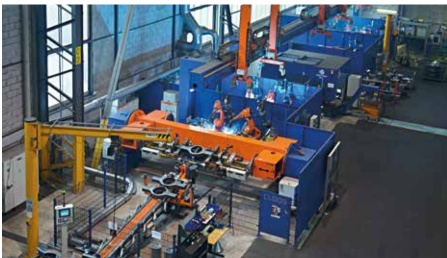
Verkettete Roboteranlage zum Schweißen von Antriebsachsbrücken für Nutzfahrzeuge bei Voestalpine.
