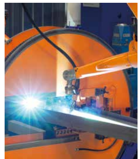
Roboteranlage zum Schweißen von Stahlbauteilen für die Hallenfertigung.
