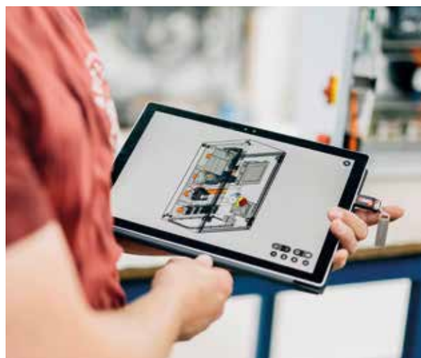
Ein digitales Abbild der Schaltschränke erleichtert künftig Konstruktion und Montage im Schaltschrankbau.
