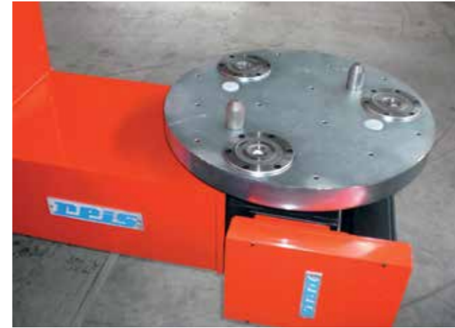
Dönme ve çevirme modülüyle bağlantılı olarak sıfır nokta germe sistemi aracılığıyla takılmış donanım.
