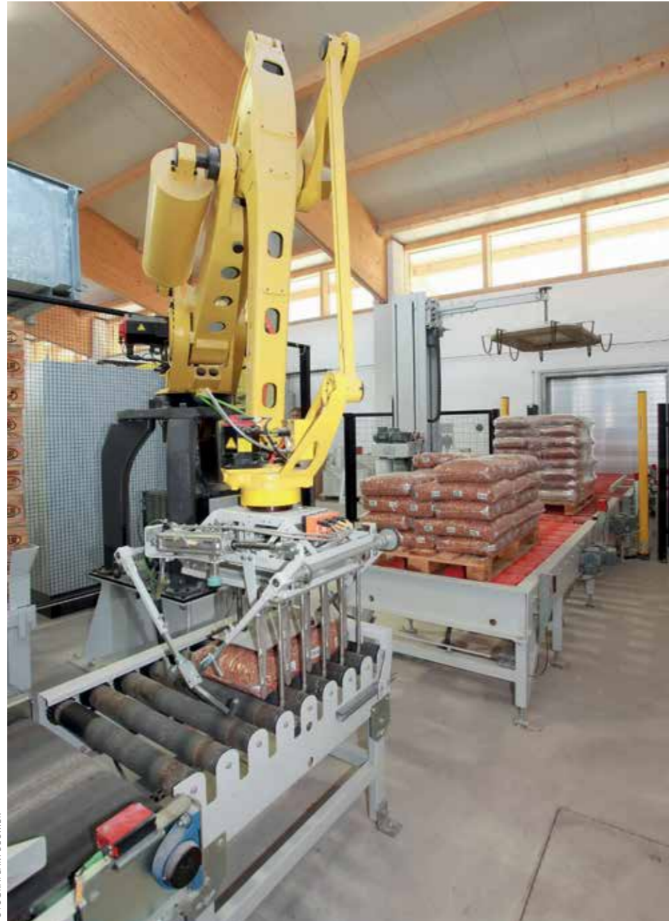
Kartonlar, kasalar, damacaneler ya da çuvallar ve kutular bir robot çözümüyle güvenli ve ekonomik biçimde istiflenebiliyor. Robot özel olarak geliştirilmiş kavrayıcı elemanlarla ve cihazlarla yüklenecek ürünleri paletliyor.
