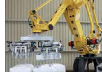
Torbalar çatallı kavrayıcıyla zarar vermeden ve verimli biçimde paletleniyor.
