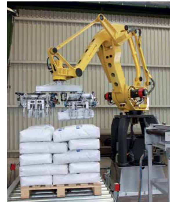
Torbalar çatalı kavrayıcıyla zarar vermeden ve verimli biçimde paletleniyor.
