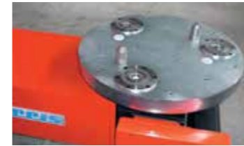
Dönme ve çevirme modülüyle bağlantılı olarak sıfır nokta germe sistemi aracılığıyla takılmış donanım.
