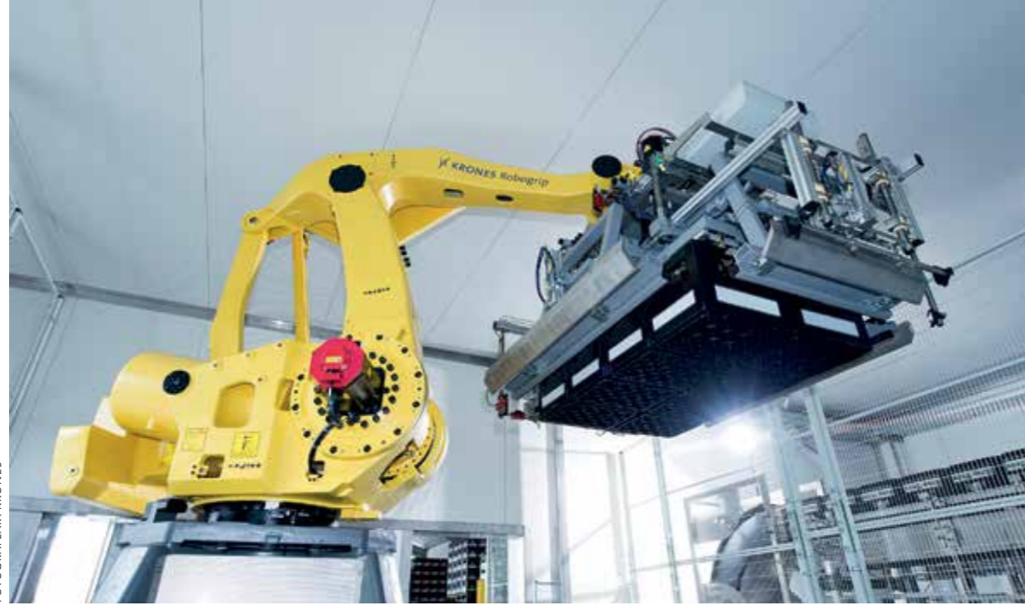
FOTOĞRAFLAR: KRONES Eklem kollu robot birden fazla işlev için kombine makine olarak kullanılabilir.
